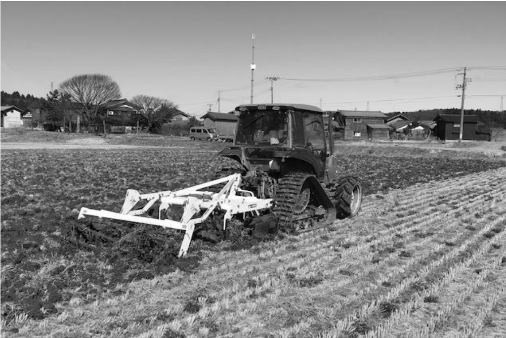
スタブルカルチという作業機で、田んぼを粗く耕起しているところ(3月9日)
